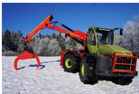
AVEC CHAUFFAGE DE STATIONNEMENT ET PRECHAUFFAGE DE L'HUILE HYDRAULIQUE, IDEAL POUR LES CONDITIONS DE FROID EXTREME,
